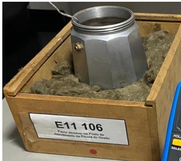
Figura 3 – Dispositivo montado com isolamento térmico
